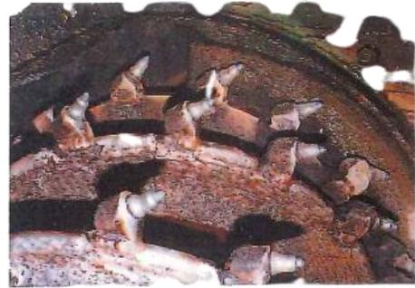
Conical bit untuk memotong
